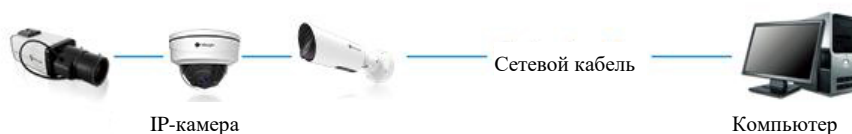
Рисунок 2-1-1. Непосредственное подключение камеры к ПК.
