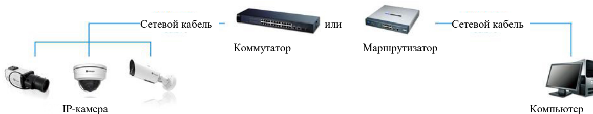
Рисунок 2-1-2 Подключение через коммутатор или маршрутизатор
